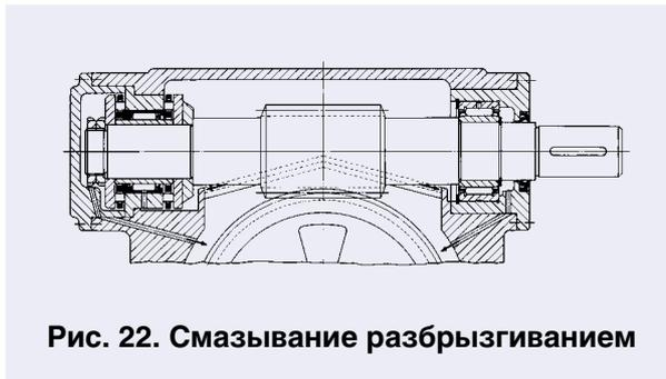
Рис. 22. Смазывание разбрызгиванием
