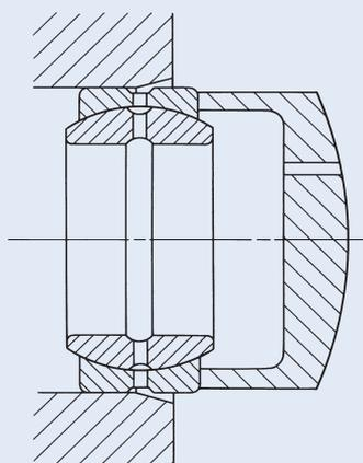
Одновременная установка внутреннего и наружного колец
