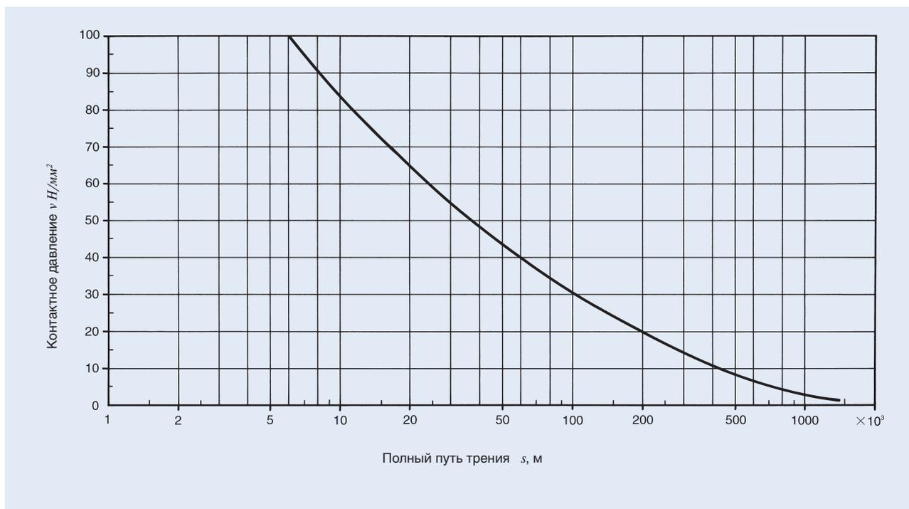
**Рис. 5. Зависимость полного пути трения от контактного давления для необслуживаемых шарнирных подшипников**
