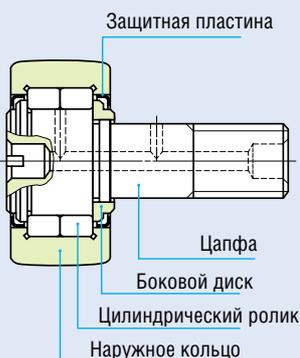
Конструкция миниатюрного опорного ролика с цапфой
