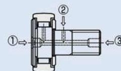
Примечания (1) Для эксцентриковых опорных роликов с цапфой (CFE) вместо диаметра цапфы применяется диаметр резьбы G, указанный в таблице размеров, и смазочное отверстие на наружной поверхности цапфы не может использоваться для смазки.
