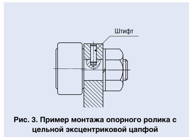
Рис. 3. Пример монтажа опорного ролика с цельной эксцентриковой цапфой
