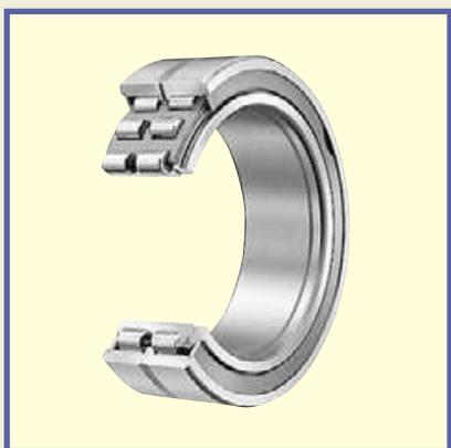
Роликовые подшипники, в которых ролики располагаются в два ряда, являются неразъемными подшипниками, предназначенными для тяжелых условий работы. Они способны нести не только радиальные, но и осевые нагрузки, которые прикладываются к бортам между плечами внутреннего и наружного колец и к торцовым поверхностям роликов. Таким образом, они наиболее пригодны для использования на фиксируемой стороне вала.
