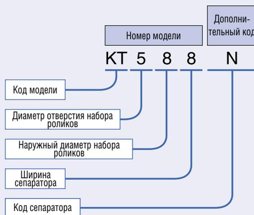
(c) Пример: “Диаметр отверстия или набора роликов + ширина”
