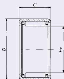
Рис. 8. Игольчатый роликовый подшипник со штампованным наружным кольцом
