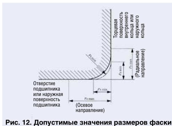
**Рис. 12. Допустимые значения размеров фаски**
