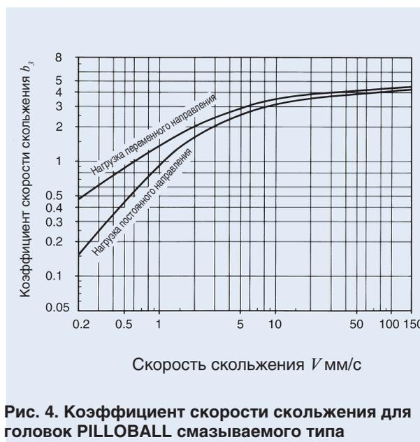
Рис. 4. Коэффициент скорости скольжения для головок PILLOBALL смазываемого типа
