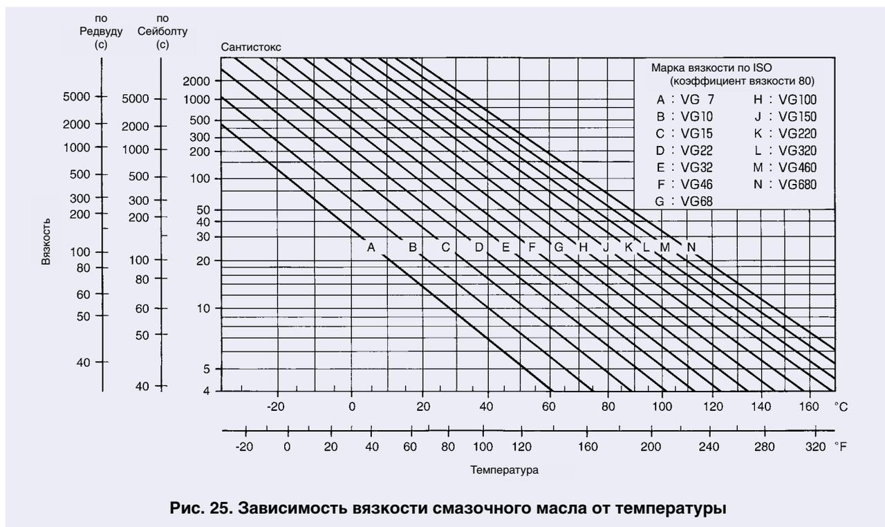
Рис. 25. Зависимость вязкости смазочного масла от температуры
