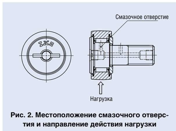
Рис. 2. Местоположение смазочного отверстия и направление действия нагрузки
