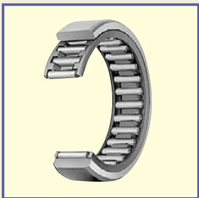
В разъемных игольчатых роликовых подшипниках с сепаратором внутреннее кольцо, внешнее кольцо и игольчатый роликовый сепаратор являются составными и легко разъединяются. Этот тип характеризуется простотой конструкции и высокой точностью. Кроме того, такая конструкция позволяет легко выбрать радиальный зазор путем выбора сборочной комбинации. Эти подшипники обладают превосходными вращательными характеристиками, благодаря использованию игольчатых роликовых сепараторов.
