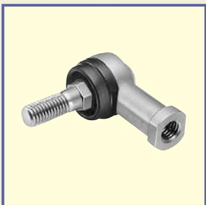
Г-образные шарнирные головки являются самоцентрирующимися и состоят из отлитого под давлением корпуса из специального цинкового сплава, и шара с резьбовой шпилькой, оси которого направлены под прямыми углами к корпусу.
