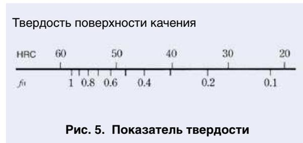
Рис. 5. Показатель твердости
