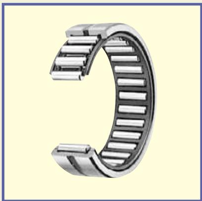
Наружное кольцо игольчатого роликового подшипника машинной обработки изготовлено путем механической обработки, с последующей термообработкой и шлифовкой. Наружное кольцо обладает устойчивой жесткостью и может легко использоваться даже в корпусах из легких сплавов.
