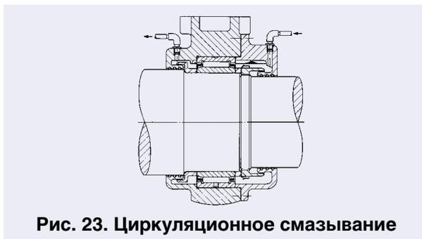
Рис. 23. Циркуляционное смазывание
