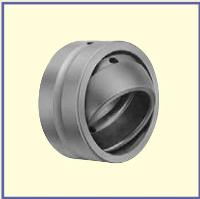
Шарнирные подшипники представляют собой самоцентрирующиеся внутренние и наружные кольца со сферическими поверхностями скольжения. Они способны одновременно нести большую радиальную нагрузку и двустороннюю осевую нагрузку.
