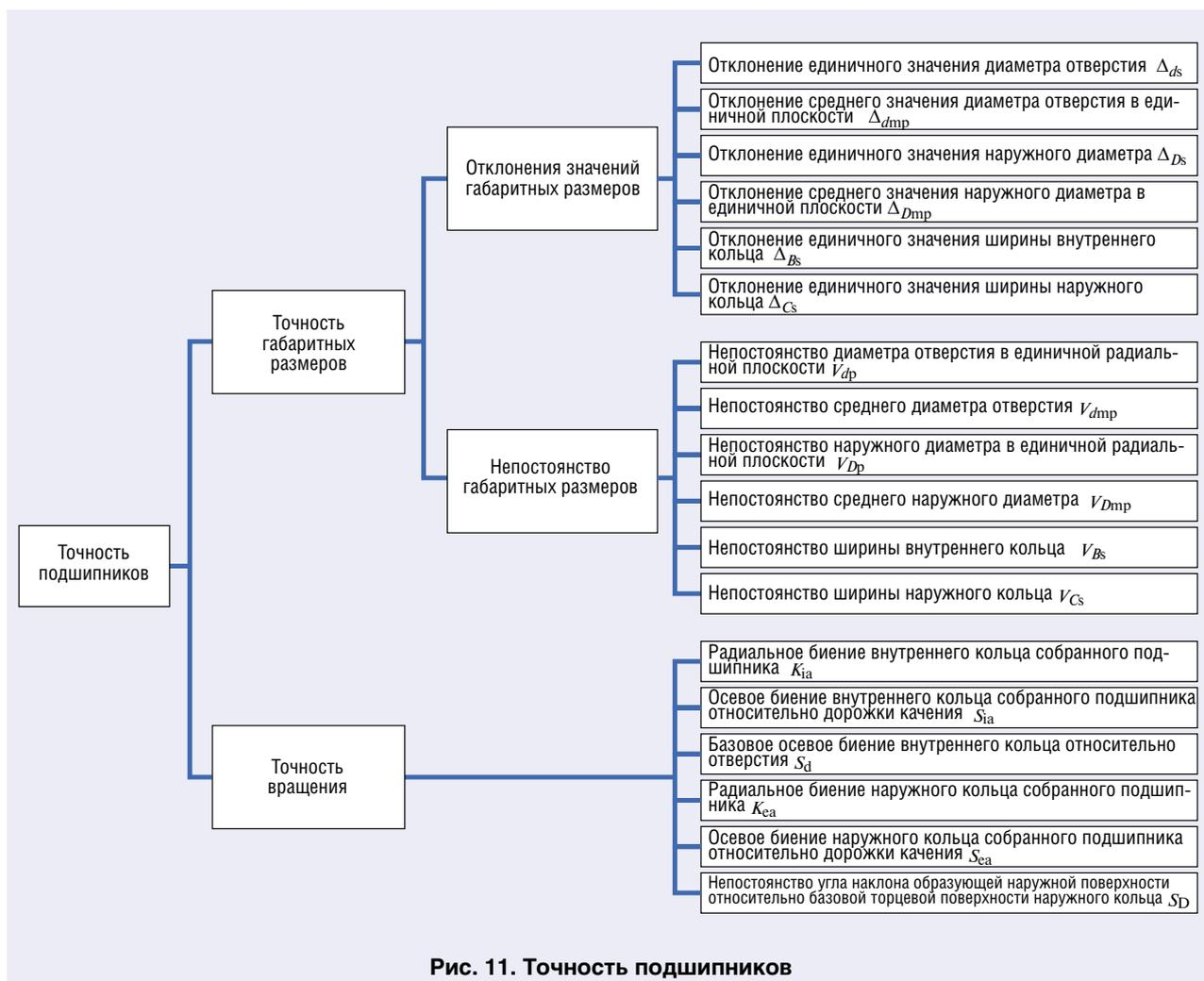
Рис. 11. Точность подшипников
