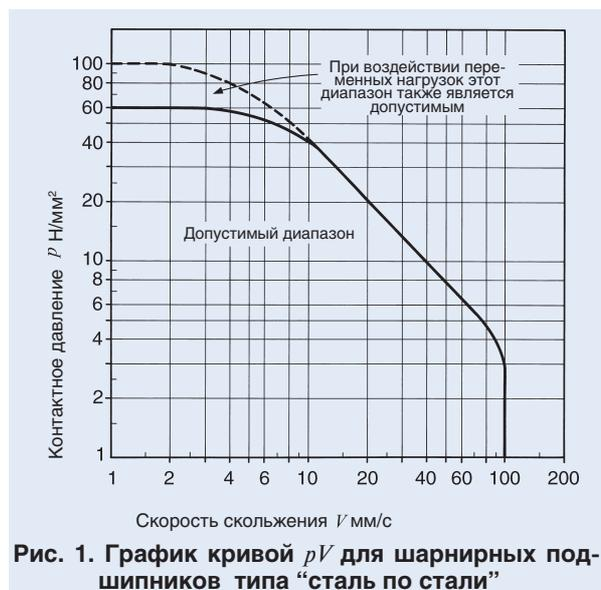
Рис. 1. График кривой  $pV$  для шарнирных подшипников типа “сталь по стали”
