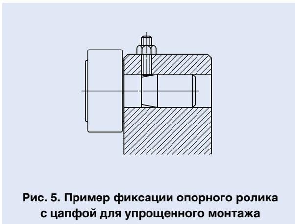
**Рис. 5. Пример фиксации опорного ролика с цапфой для упрощенного монтажа**
