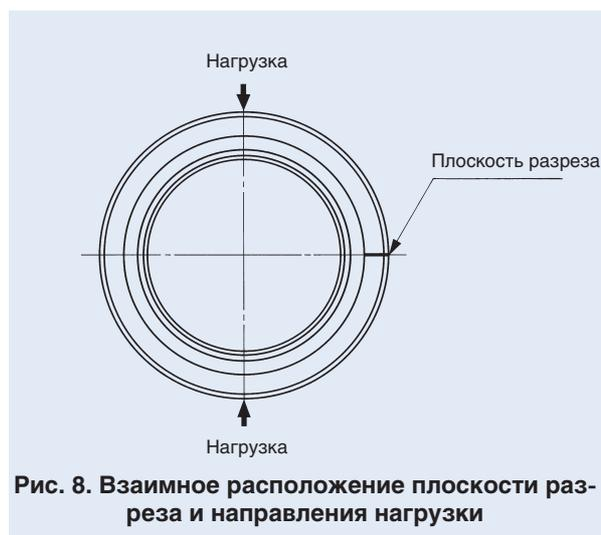
Рис. 8. Взаимное расположение плоскости разреза и направления нагрузки
