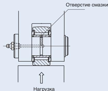
Рис. 2. Положение смазочного отверстия и направление действия нагрузки
