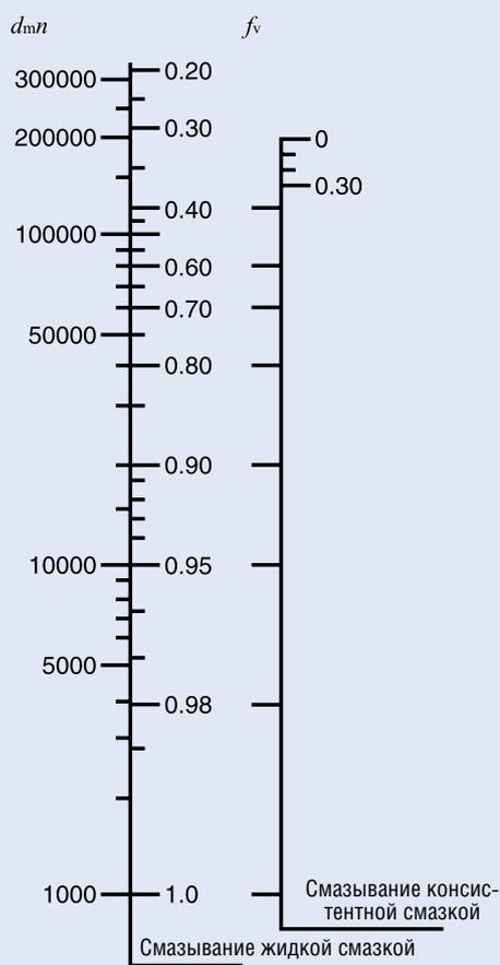
Рис. 2. Коэффициент поправки на скорость
