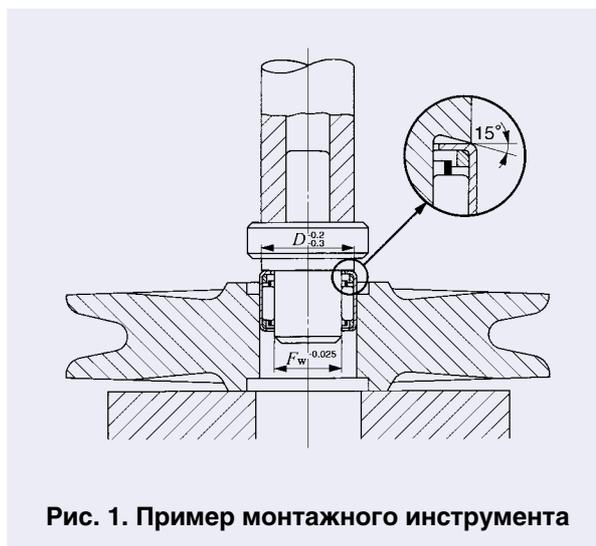
**Рис. 1.** Пример монтажного инструмента
