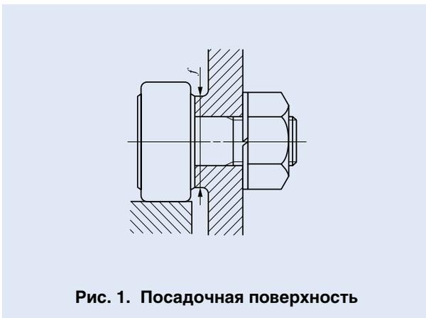
Рис. 1. Посадочная поверхность
