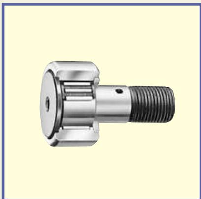
Опорные ролики с цапфой представляют собой подшипники с цапфой, в которую установлены игольчатые ролики в толстостенном наружном кольце. Конструкция предназначена для вращения наружного кольца, которое движется непосредственно по сопряженным трековым поверхностям. Предлагаются опорные ролики с цапфой самых разных типов. Они широко используются в качестве опорных роликов для кулачковых механизмов и линейных перемещений.
