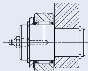
Рис. 3. Пример монтажа опорного ролика без внутреннего кольца
