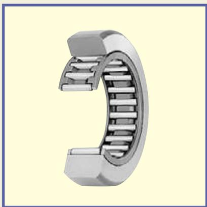
Опорные ролики представляют собой подшипники, игольчатые ролики которых заключены в толстостенное наружное кольцо. Эти подшипники предназначены для вращения наружного кольца, которое движется непосредственно по сопряженным трековым поверхностям. Они используются в качестве опорных роликов для кулачковых механизмов и линейных перемещений.
