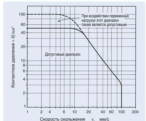
**Рис. 4. График кривой  $pV$  для необслуживаемых шарнирных подшипников**
