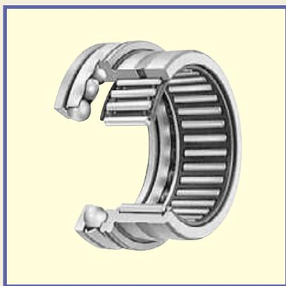
Комбинированные игольчатые роликовые подшипники представляют собой комбинацию радиального и упорного подшипников. Сепаратор игольчатого роликового подшипника используется в качестве радиального подшипника, а упорный шариковый или роликовый сепаратор – в качестве упорного подшипника.
