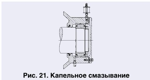
Рис. 21. Капельное смазывание
