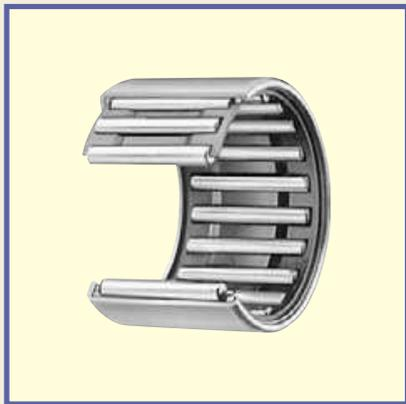
Среди игольчатых роликовых подшипников с наружным кольцом, легкие игольчатые подшипники со штампованным наружным кольцом имеют наименьшую высоту сечения, благодаря использованию наружного кольца в виде оболочки, изготовленной из точно вытянутой, цементованной и закаленной специальной тонколистовой стали.
