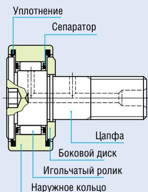
Конструкция опорного ролика с цапфой и упорным диском
