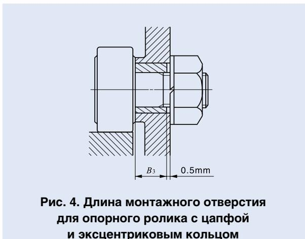
**Рис. 4. Длина монтажного отверстия для опорного ролика с цапфой и эксцентриковым кольцом**
