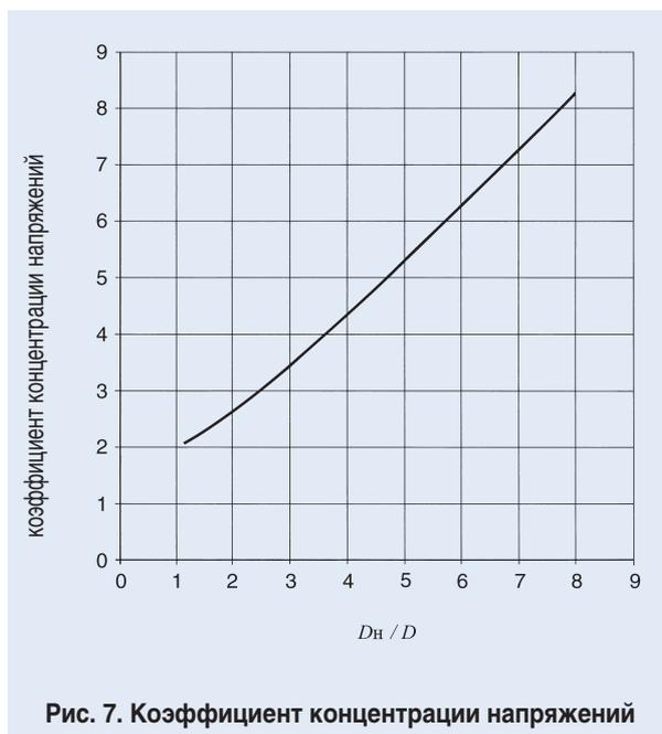
Рис. 7. Коэффициент концентрации напряжений
