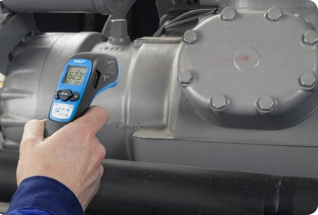
При использовании бесконтактного режима измерений термометр воспринимает тепловую энергию, излучаемую объектом, с помощью инфракрасного детектора. При наведении на объект, инфракрасный датчик собирает энергию, производя сигнал, который микропроцессор транслирует как значение на экране.
