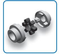
Для работы с более высокими нагрузками и обеспечения безремонтной эксплуатации были разработаны соединительные муфты типа FRC, способные амортизировать умеренные ударные нагрузки, гасить небольшие вибрации и компенсировать случайные нарушения соосности. Муфты FRC имеют фосфатное покрытие для повышения коррозионной стойкости и оснащены огнестойкими и антистатическими упругими элементами (F.R.A.S.). Поставляются в исполнениях с “черновым”
